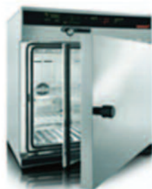
camere climatiche per test di stabilità
