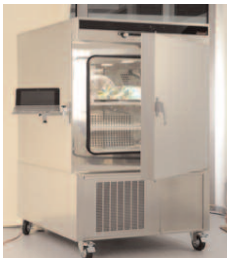
Camera climatica per test materiali CTC 256 con controllo di temperatura e umidità -42 ... +190 °C / 10 ... 98% rh
